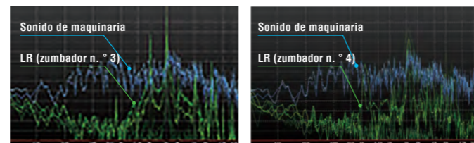
(Zumbador n.º 3) Sonido rápido alto-bajo 2016 Hz / 3012 Hz (Zumbador n.º 4) Sonido de barrido 1000Hz - 4032Hz (cambiando)
