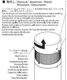
■ 取付け / Attachment / Anbringen / Fixation Accessorio / Conexión ■ 位置決め用マーク Positioning Mark / Positionsmarkierung / Repère de positionnement / Riferimento di posizionamento / Marca de positionemento / Marca de positionemianto / Marca de positionemian ロック解除時 / Unlocked / Entriegelt / Déverrouillé / Sbloccato Desbloqueado ロック時 / Locked / Verriegelt / Verrouillé / Bloccato / Bloqueado 4
