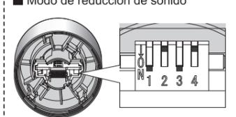
Conmutador DIP (Cuando está hacia abajo, está "ENCENDIDO") El conmutador se muestra mediante ■.
